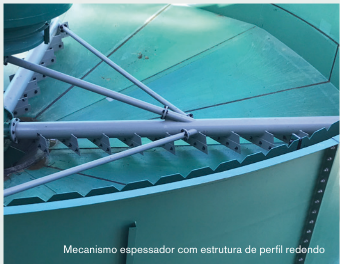
Espessador aparafusado de 60 m no Vietnã
